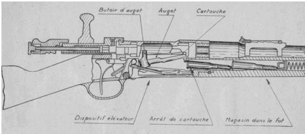
Par contre le Lebel peut tirer en automatique ou au coup par coup suivant la façon dont on positionne l'auget situé en bas du boîtier de culasse .
