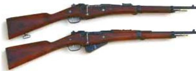
Le "nouveau" fusil prend l'appellation de fusil de 8 mm Mle 1916 lorsqu'il est fabriqué neuf et de 07-15 M16 lorsqu'il provient de la modification d'un 07-15.
