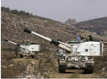
Il s'agit d'un canon automatique de 155 mm monté sur un châssis AMX 30 .
